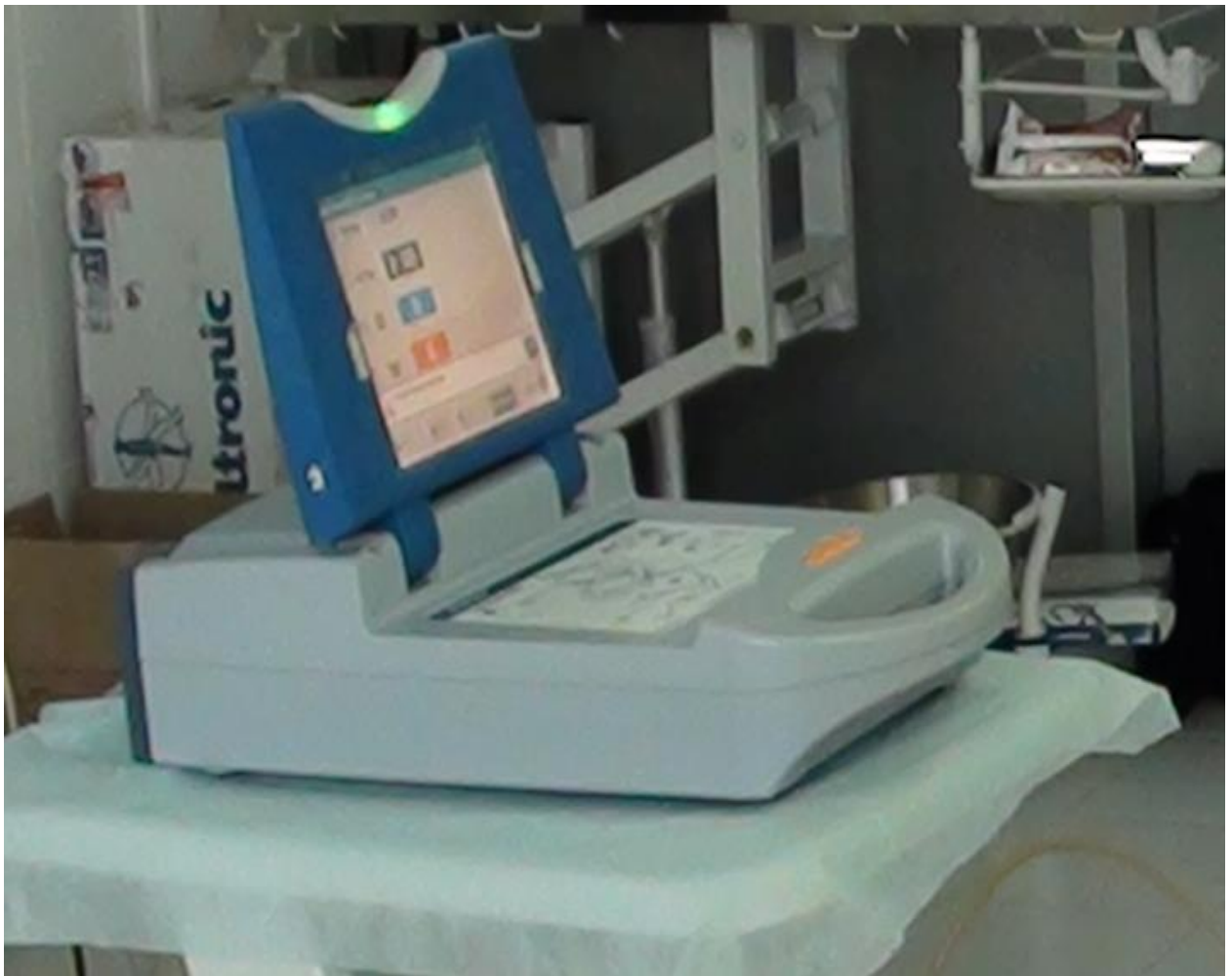
Рисунок 15. Радиочастотный генератор с функцией автоматического подбора параметров воздействия.
